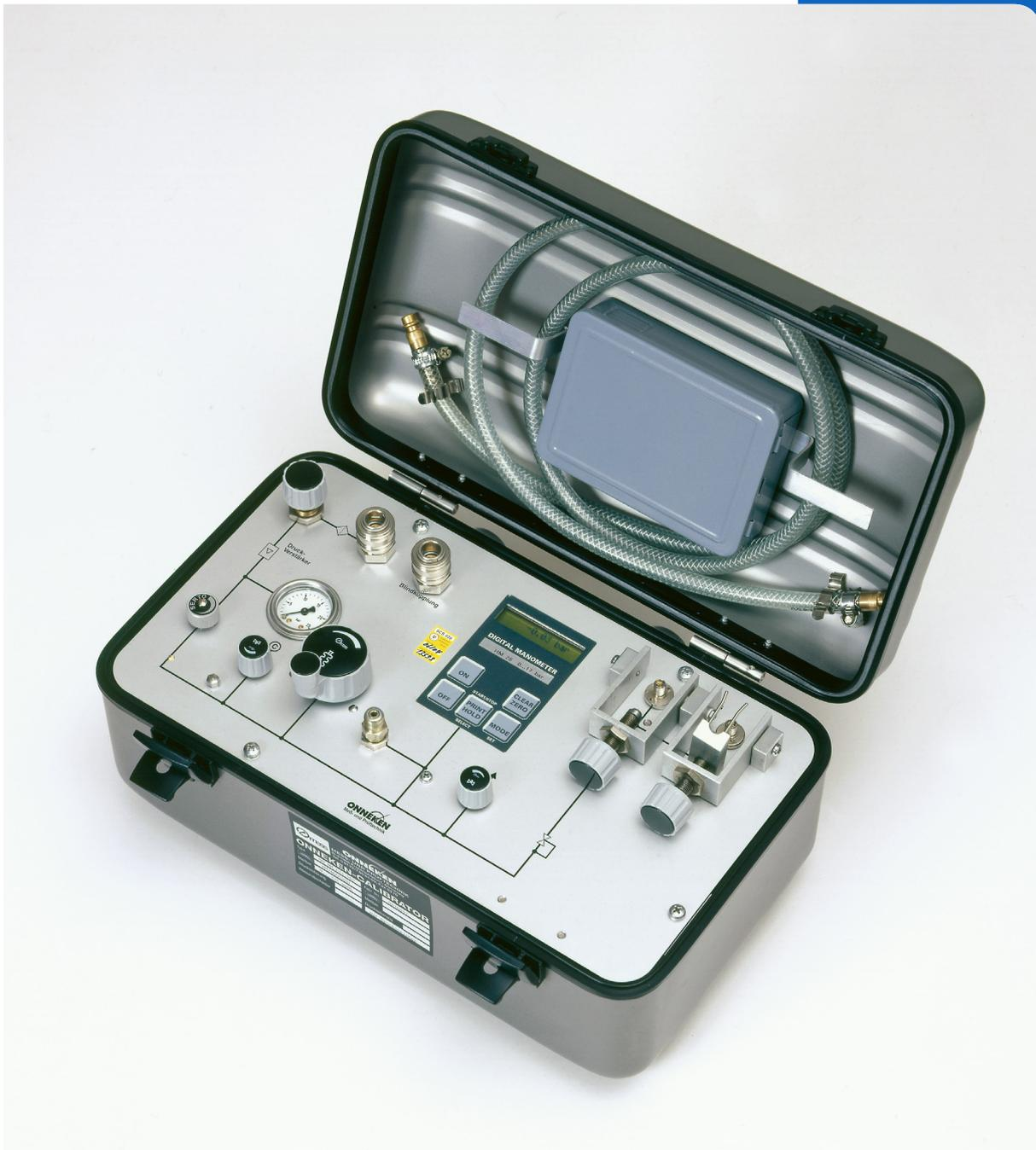
Der Omess-Calibrator ist bestimmt, um vor Ort, z.B. an Tankstellen oder bei Reifenfachbetrieben, stationäre oder ambulante Reifendruckmanometer zu eichen oder zu kalibrieren. Das Gerät ist mit einem
